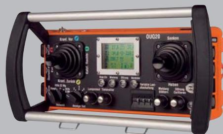
spectrum 3 со сверхбольшим ЖК дисплеем, различными светодиодами и другими специфическими для пользователя органами управления.
